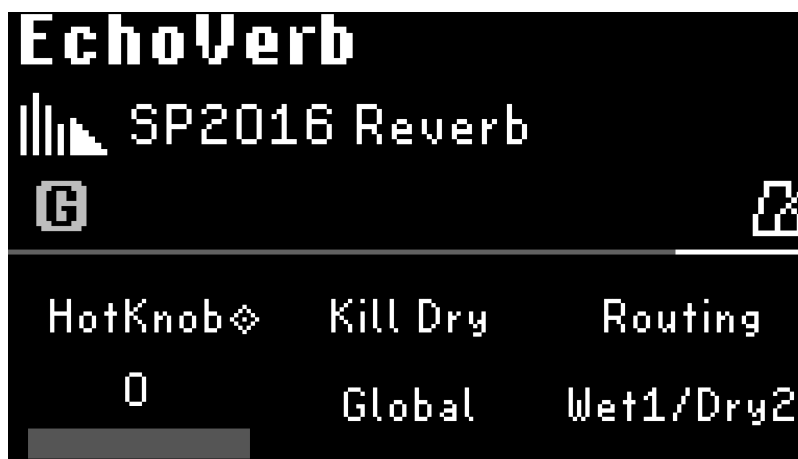
図 3.5 SP2016 Reverb Presetは、Wetアンプに出力されます。
