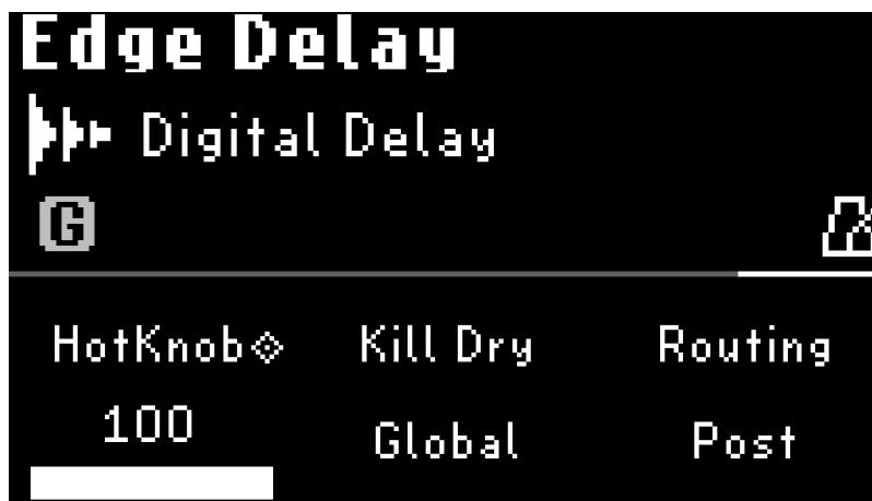
図 3.8 Digital Delay Presetは「Post」Pathにあります。
