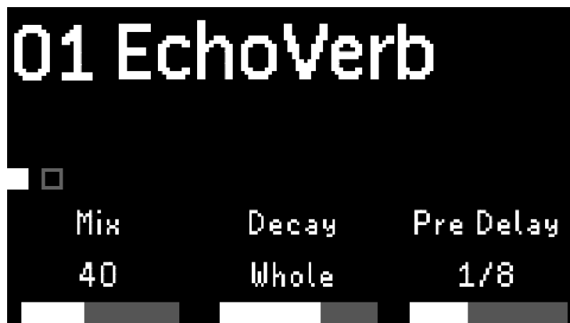
図 5.6 Mix、Decay、Pre DelayがQuick Knobに割り当てられています。
